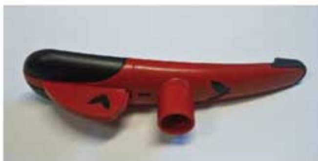
Assicella (matrioska) per scopa Vileda: la parte inferiore dovrà ricevere i "fili" che formano la scopa vera e propria mentre sulla parte superiore viene avvitato il manico. La matrioska si scompone di due parti unite mediante un attacco a scatto: la parte più piccola è impiegata come elemento per raccogliere lo sporco residuo che resta dopo l'uso della scopa
