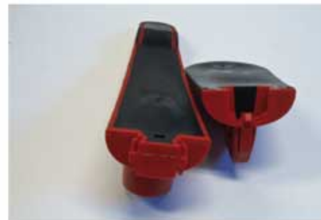
Dettaglio dell'attacco a scatto che unisce le due parti del pezzo: sono ben visibili i due materiali principali (rosso il polipropilene vergine costituente il guscio del pezzo, nero il polipropilene riciclato di riempimento)
