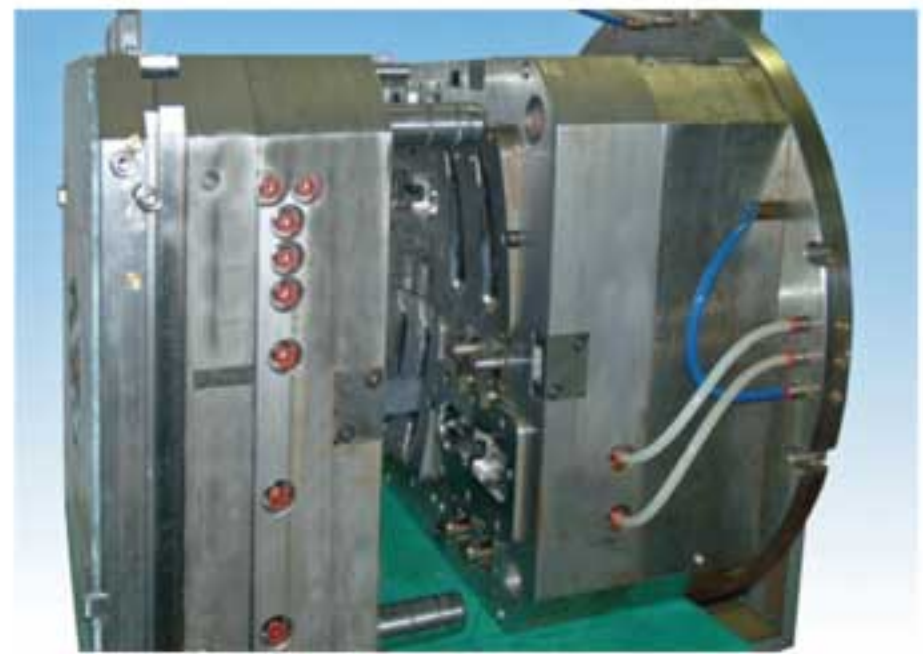
Lo stampo completo in posizione di semiapertura
