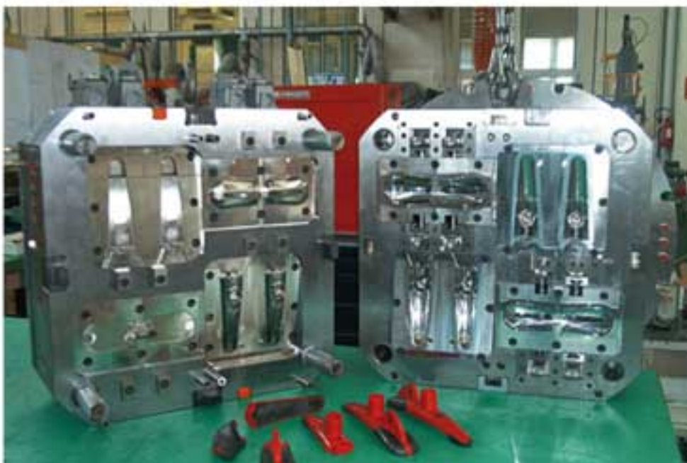
Lo stampo aperto: in primo piano matrioske complete e matrioske scomposte
