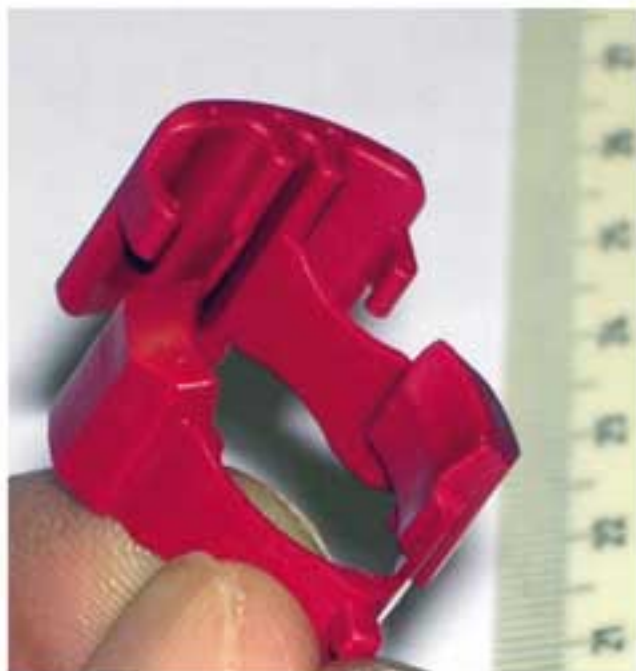
Il pezzo: un tasto per interruttore. Realizzato in resina acetica con aggiunta di elastomero, esso va prodotto in grande serie ed è destinato al montaggio automatico su linee robotizzate: pertanto, è indispensabile che esso esca dallo stampo totalmente finito, senza necessità di riprese per finitura e con precisione costante sull'intera produzione
