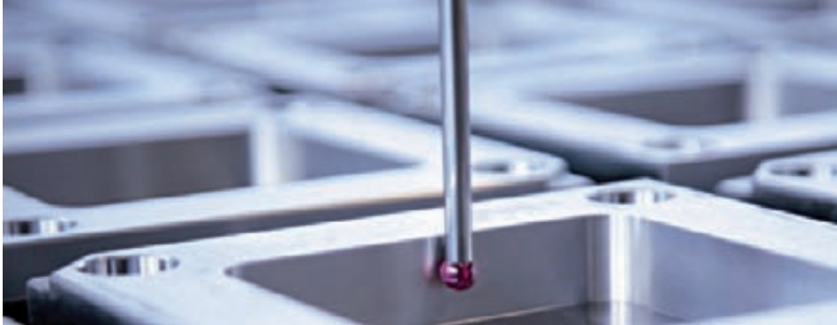
I prodotti finiti di Meusburger sono sottoposti ad un controllo di precisione con la macchina di misurazione Zeiss sino a 0,003 mm di esattezza
