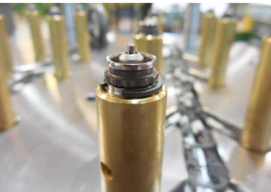
Sistema di iniezione multicavità dotato di ugelli speciali per applicazioni con materiali riciclati
