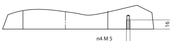
STRAIN RELIEF FITTING / PRESSACAVO DI RICAMBIO
