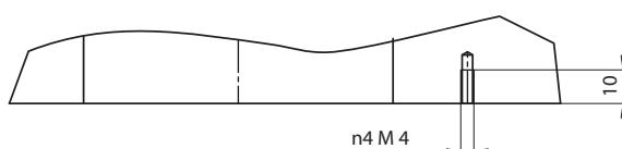
Per il fissaggio delle custodie utilizzare n4 M4x12 UNI 5931
