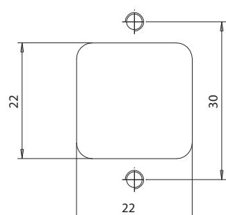
Per il fissaggio delle custodie utilizzare n2 M3x10 UNI 5931
