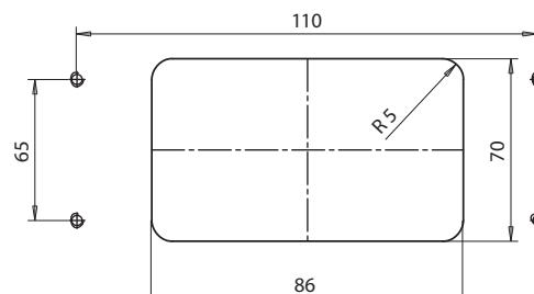
Per il fissaggio delle custodie utilizzare n4 M5x12 UNI 5931
