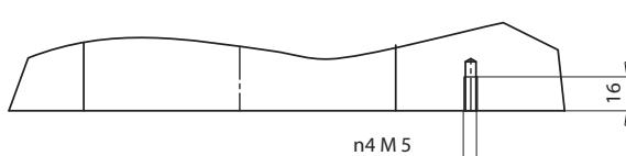
PRESSACAVO DI RICAMBIO / SERRE CABLE DE RECHANGE
