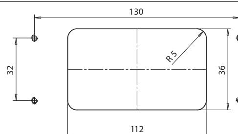
Per il fissaggio delle custodie utilizzare n4 M4x12 UNI 5931
