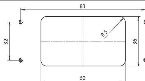
Per il fissaggio delle custodie utilizzare n4 M4x12 UNI 5931
