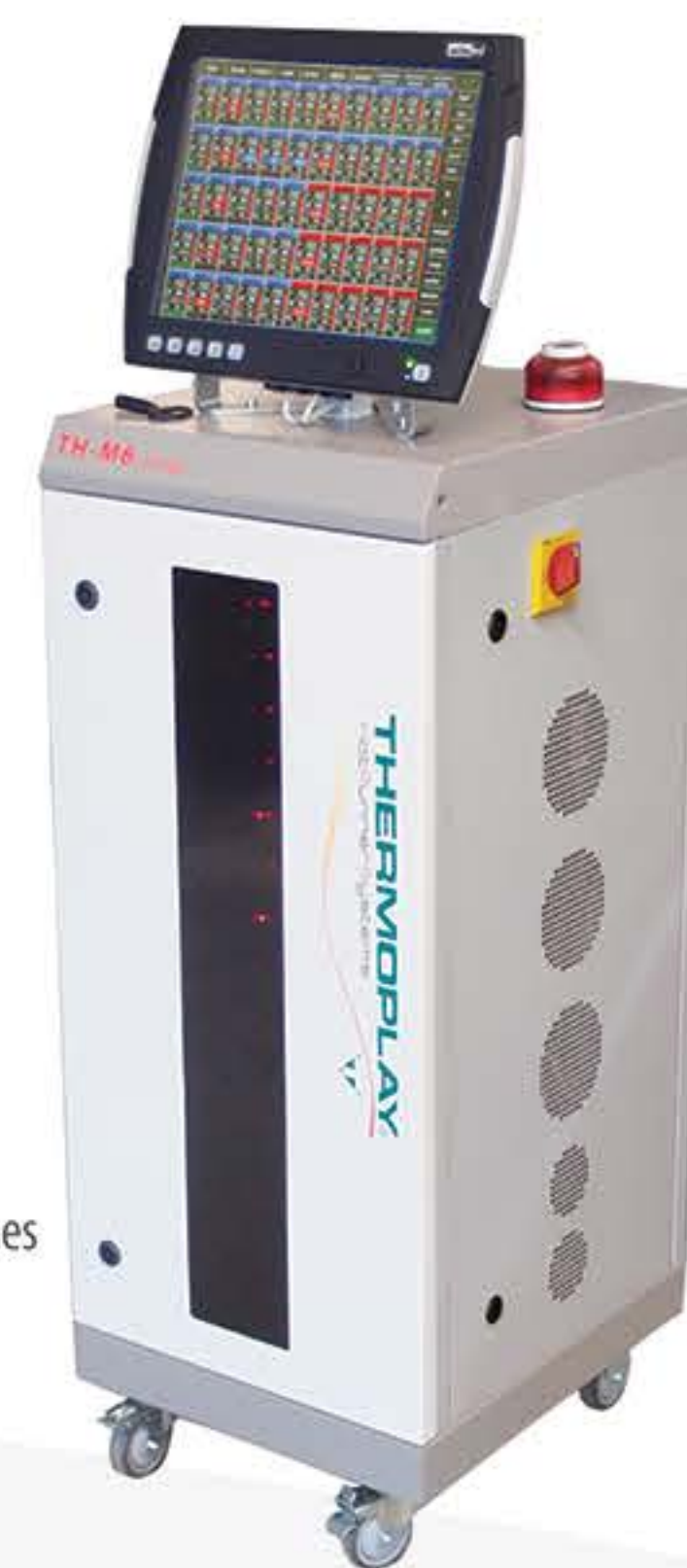
24-240区段温控器 每组控制6区段 24÷240 zones, modules of 6 zones (... , 48, 54, ..., 240)
