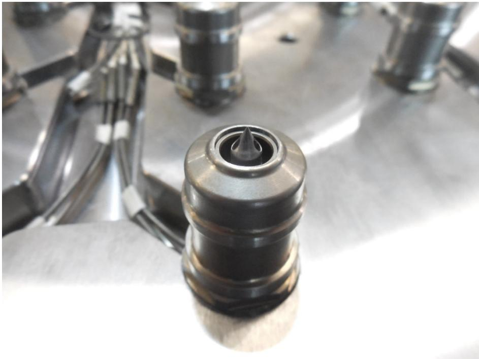
Fig. 1 Sistema Thermoplay con 16 boquilla TF provisto de casquillos D-Bushing (© Thermoplay)
